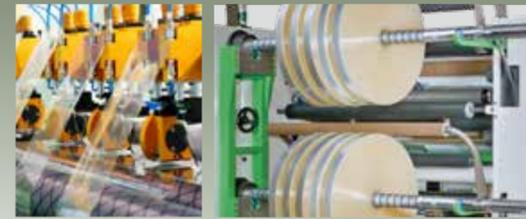
FSL-TX系列分條複捲機專為大卷徑收料需求所設計，成品直徑可達800MM，分條速度可達每分鐘400米。堅固的放料結構可承載直徑1000MM，重達1噸之原料。
